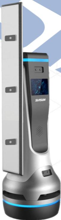
新松视觉盘点机器人通过CCD扫描器、激光扫描器、光笔扫描器等识读设备扫描条形码、二维码的商品，实时监控商品库存情况。机器人盘点的数据可作为商场进货的参考数据，解决盘点高人力成本、人工准确率不高、数据无法直传、线上线下内外部库存无法统一管理等问题，为实体零售行业带来创新型解决方案。
